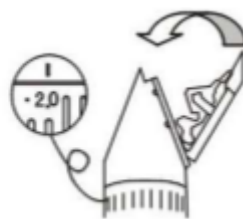
Montáž čepele při nastavení délky stříhání 2 mm.
